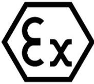
Die Lineareinheiten sind für die Verwendung in potentiell explosiver Atmosphäre nicht geeignet.
