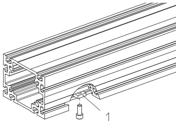
*Bild 2: Nutensteine (1) in der Nut an der Unterseite des Grundprofils*
