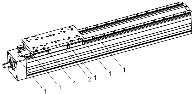
Bild 9: Mögliche Schmierpunkte (1 u. 2) am Schlitten
