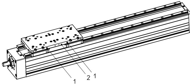
Bild 8: Mögliche Schmierpunkte (1 oder 2 u. 3) am Schlitten
