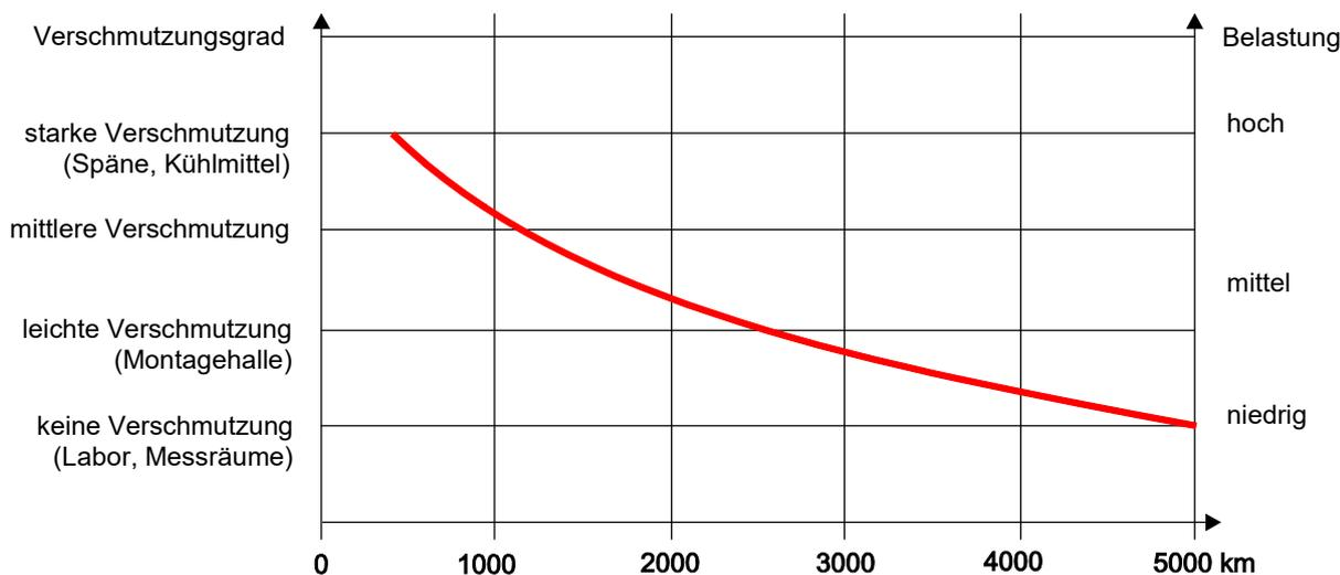
Bild 10: Nachschmierintervalle für die Kugelumlaufführung mit Kugelmutter
