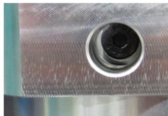
Spannschraube in Klemmnabe mit passendem  $M_A$  anziehen, Verschlussstopfen aufstecken.
